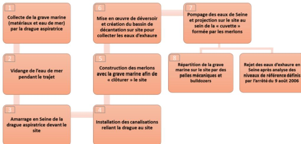
*Etapes du transfert de matériaux de remblaiement par drague aspiratrice et canalisations marines et terrestres*
